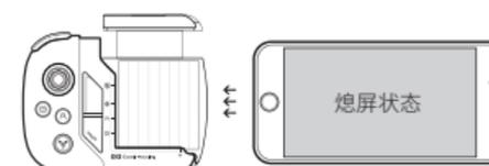
5. 在拉杆上方按压拉杆直到与手机侧面贴合
