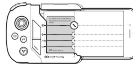
图示手柄刻度 X、Y 轴交汇点即为对应按键的固定映射点(可将映射标尺贴到手机屏幕上辅助定位)
